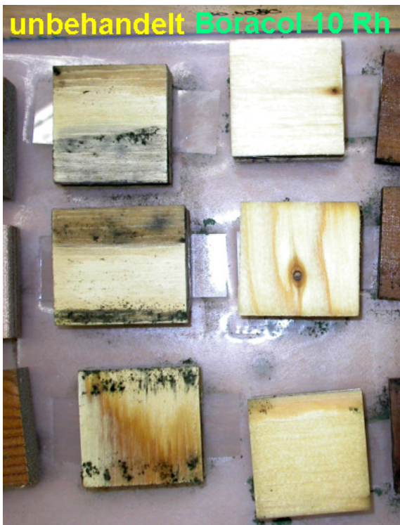
Versuch der MPA Bremen, M 7000-04 in Anlehnung an DIN EN 846.
